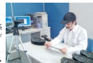
EyeMarkレコーダーによる目視検査技能の解析実験▶
