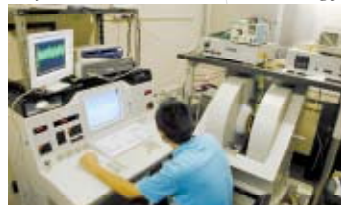
▲時間分解型電子スピン共鳴分光装置によるラジカル検出
