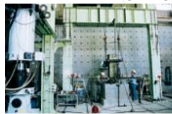
▲構造物の耐震性能試験システムによる繊維シート補強柱の交番載荷実験
